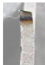
Uma abrasão excessiva na ponta é sinal de que a roda CBN começou a esmerilar na ponta do dente e não "inserida" no perfil da lâmina.
