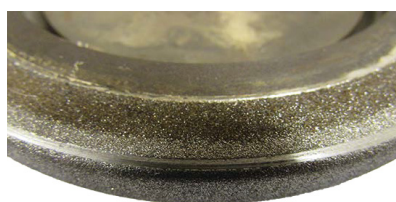
Roda CBN danificada por esmerilamento prematuro da ponta do dente.
