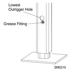
FIG. 4-8. FINE ADJUST OUTRIGGER ONLY.
