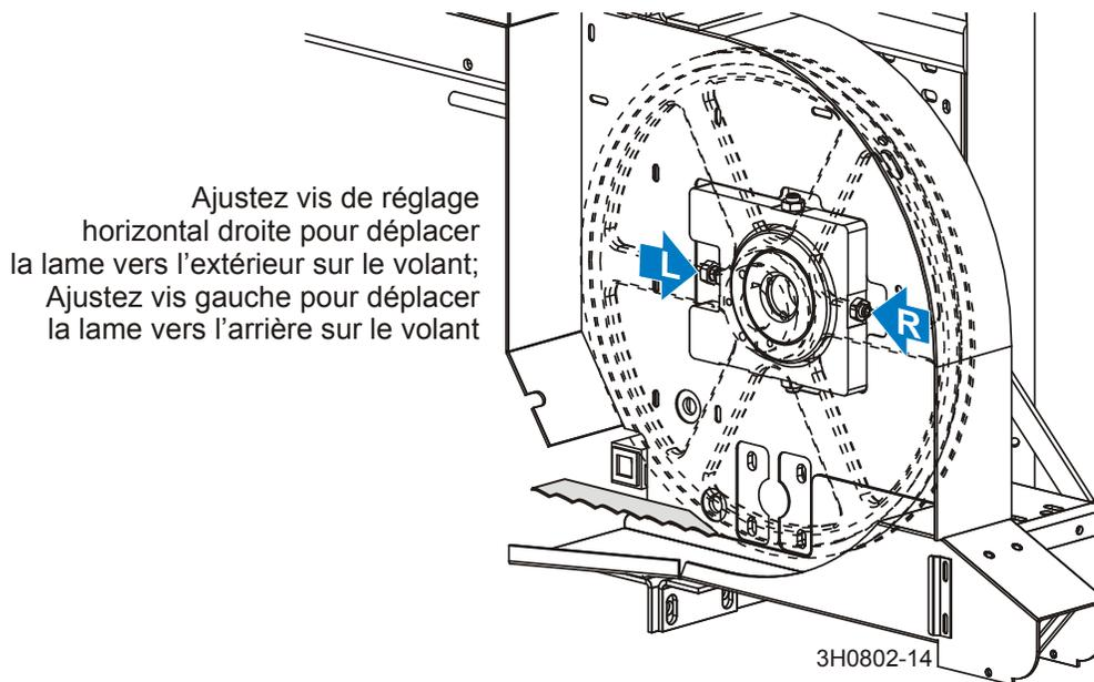
Ajustez vis de réglage horizontal droite pour déplacer la lame vers l'extérieur sur le volant; Ajustez vis gauche pour déplacer la lame vers l'arrière sur le volant
