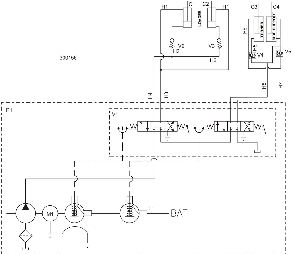
FIG. 8-1 CARREGADOR/DISPOSITIVO DE ROTAÇÃO DE TORAS HIDRÁULICOS OPCIONAIS
