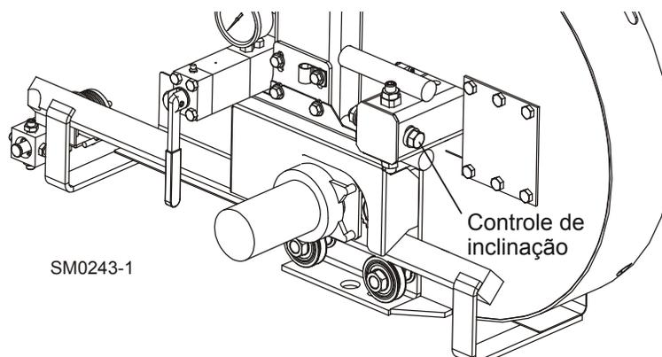
Girar o controle de inclinação no sentido horário para afastar a lâmina da roda;
