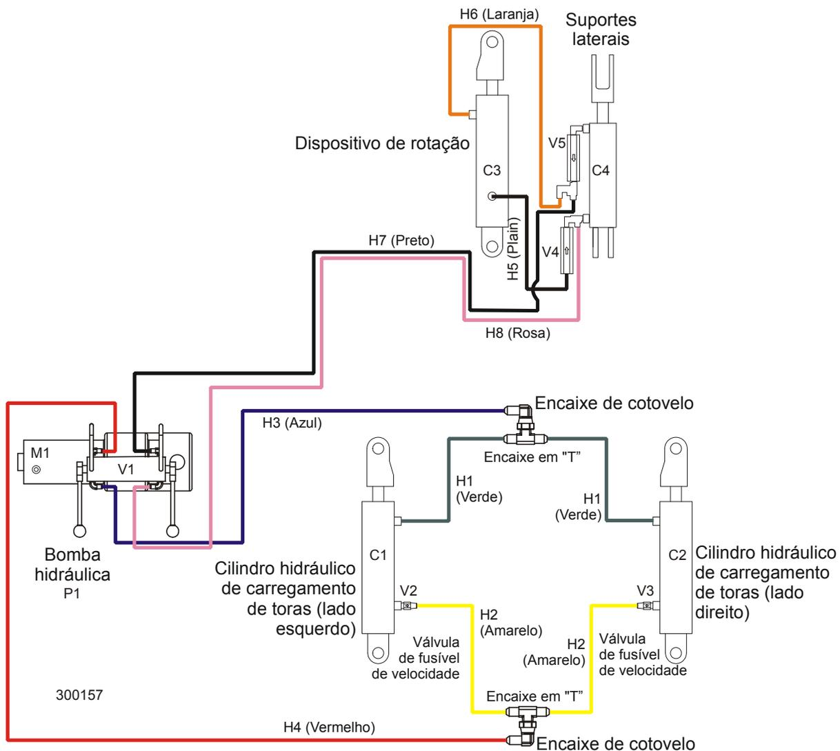
**FIG. 8-2 DIAGRAMA DE INSTALAÇÃO DO CARREGADOR/DISPOSITIVO DE ROTAÇÃO HIDRÁULICOS OPCIONAIS.**
