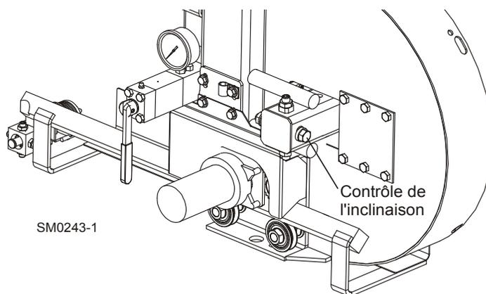
Tournez-le contrôle des aiguilles d'une montre pour déplacer la lame vers l'extérieur sur le volant; inverse des aiguilles d'une montre pour déplacer la lame vers l'arrière sur le volant
