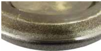
Rueda CBN dañada debido a un esmerilado prematuro.
