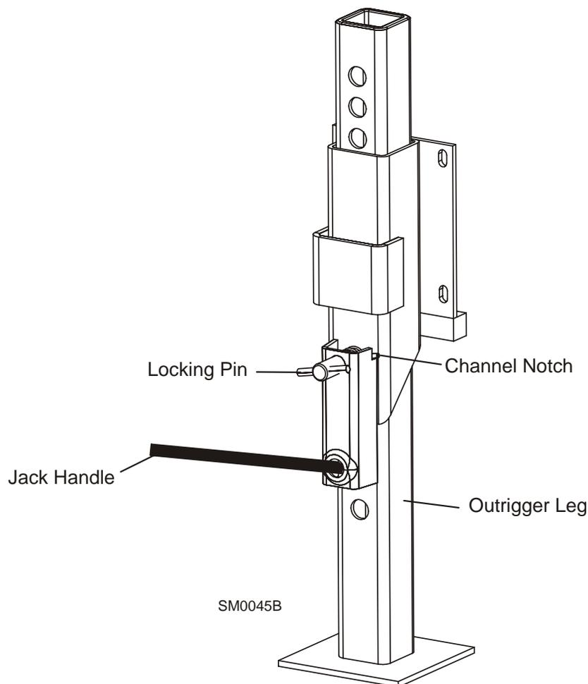
**FIG. 3-14. OUTRIGGER ADJUSTMENT.**
