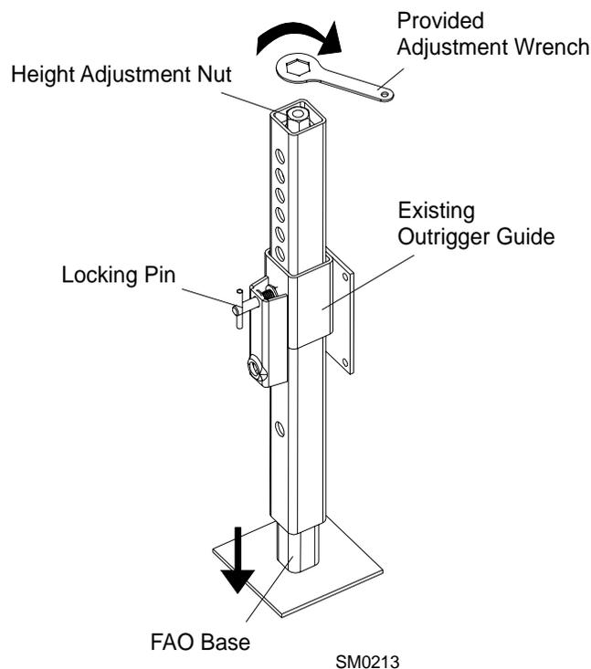
**FIG. 3-15. BASE HEIGHT ADJUSTMENT (FOR FINE ADJUST OUTRIGGER ONLY).**
